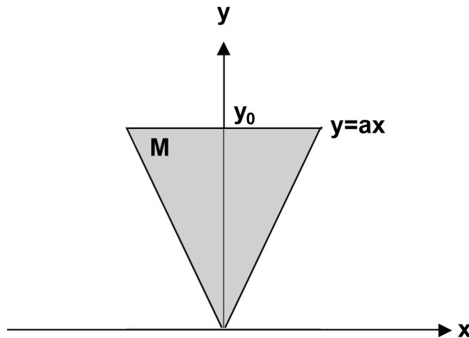
Det trekant-formede legemet i figuren over har en masse  $M$  som er jevnt fordelt over hele arealflaten. Et koordinatsystem er plassert slik at legemet er symmetrisk om  $y$ -aksen og der de skrå sidekantene er gitt ved funksjonene  $y = \pm ax$ , der  $a > 0$ . Legemets høyde relativt til  $x$ -aksen er  $y_0$ .
