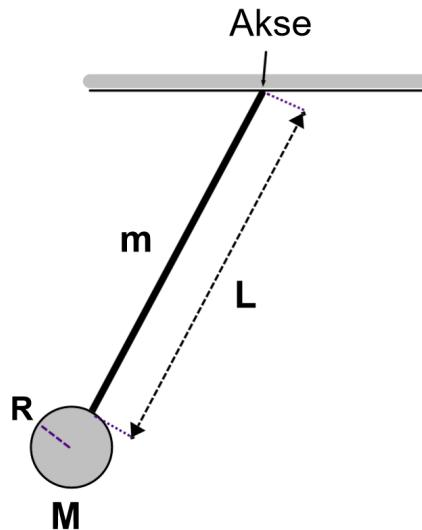
Ei massiv kule med masse  $M$  og radius  $R$  er festet i enden av ei stiv stang med masse  $m$  og lengde  $L$ . Stanga er festet til overflata av kula samt i et aksepunkt oppe i taket slik figuren over viser. Både kula og stanga har jevn massefordeling.
