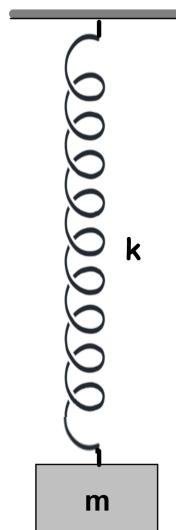
Et lodd med masse  $m = 0.50 \text{ kg}$  er festet til ei fjær med gitt stivhet  $k$ . Loddet gjennomfører dempede svingninger der amplituden i det svingbevegelsen påbegynnes er  $A_0$ . Tiden det tar innen denne amplituden er redusert ned til  $A_0/2$  er **10 s**.
