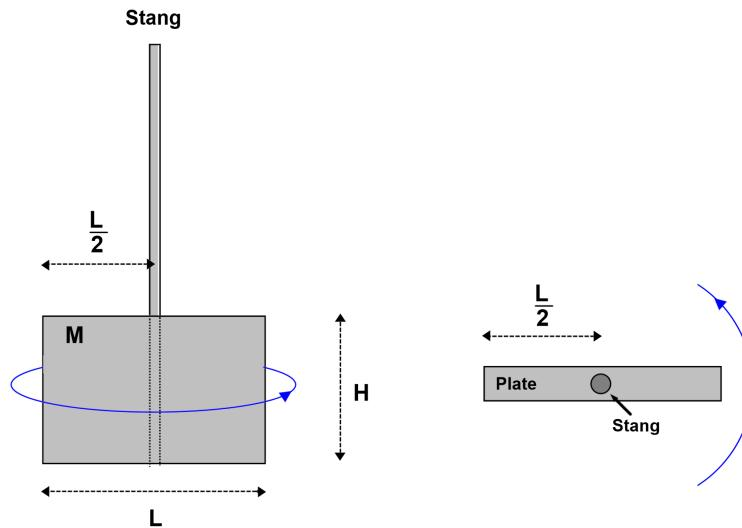
Ei tynn plate med jevn massefordeling har masse  $M$ , bredde  $L$  og høyde  $H$  (se venstre del av figuren). Plata er festet til ei tynn stang som går gjennom platas massemiddelpunkt (se høyre del av figuren). Plata og stanga roterer som et felles legeme om en akse som går gjennom massemiddelpunktet til stanga.
