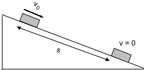
Et legeme med startfart  $v_0 = 3.40 \text{ m/s}$  glir nedover et skråplan. På grunn av ei konstant friksjonskraft stopper legemet opp etter å ha forflyttet seg en distanse  $s = 2.30 \text{ m}$ . Dersom nettokrafta  $\sum F$  på legemet utøver en impuls lik  $2.55 \text{ kgm/s}$  på legemet, hva er verdien til  $\sum F$ ?
