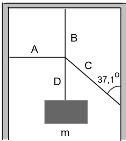
Figuren over viser et legeme med masse  $m = 409 \text{ kg}$  som er festet i et system av masseløse kabler A, B, C og D. Kabel A er horisontal, Kabel B og D er begge vertikale mens kabel C danner en vinkel på  $37,1^\circ$  med den vertikale veggen.
