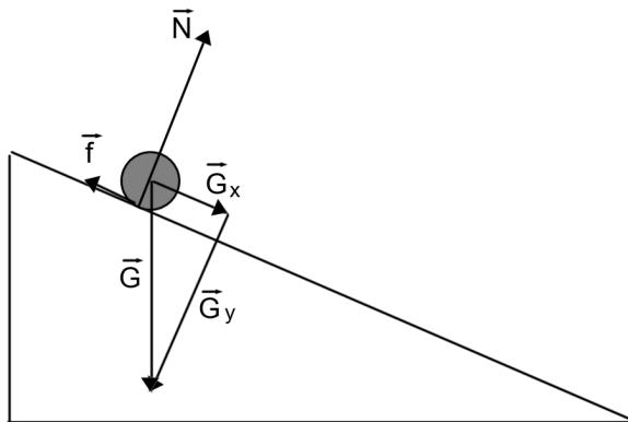
Figuren over viser kraftdiagrammet på ei kule med jevn massefordeling som ruller uten å gli nedover et skråplan. Kreftene som virker på kula er henholdsvis tyngdekrafa  $\vec{G}$ , normalkrafa  $\vec{N}$  og friksjonskrafa  $\vec{f}$ . Hvilke(n) kraft/krefter er det som produserer et kraftmoment om kulas sentrum?
