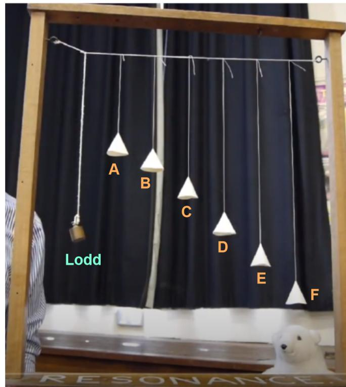
Bildet viser en lodd-pendel (lengst ut til venstre) og seks ulike papirpendler (A-F). Loddpendelen trekkes utover og slippes slik at den begynner å svinge med svingefrekvens  $\omega$ . Som en konsekvens av lodd-pendelens svingbevegelse transporteres det mekanisk energi langs den horisontale snora som de ulike papir-pendlene er festet i.
