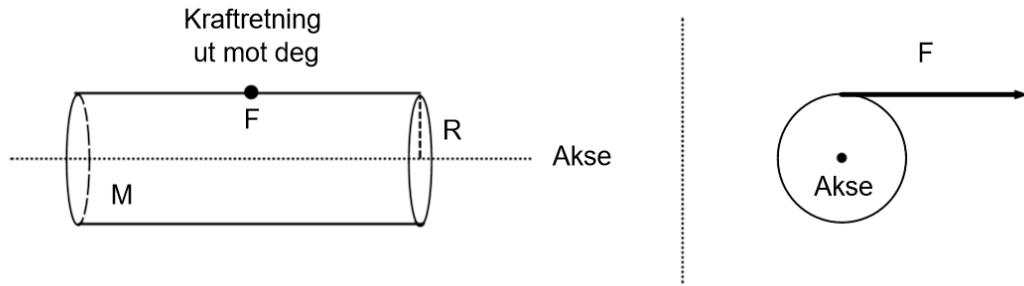
En sylinder med radius  $R = 0.40 \text{ m}$  og masse  $M = 8.0 \text{ kg}$  roterer omkring en akse slik figuren til venstre viser. Sylinderen har jevn massefordeling og aksen går gjennom sylinderens CM. Anta at sylinderens vinkelfart øker fra  $\omega_1 = 2.0 \text{ 1/s}$  til  $\omega_2 = 8.0 \text{ 1/s}$  på grunn av at ei tangentell kraft  $F = 30 \text{ N}$  virker på sylinderoverflaten slik som figuren til høyre viser.
