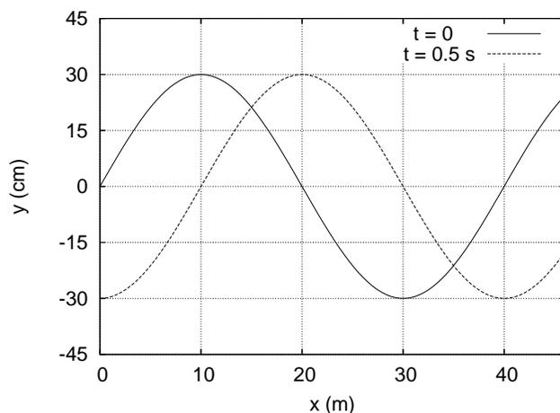
Figur 1 gjelder oppgavene 3-6 og viser to øyeblikksbilder av (en del av) en harmonisk transversal bølge som forplanter seg i positiv  $x$ -retning på en streng.
