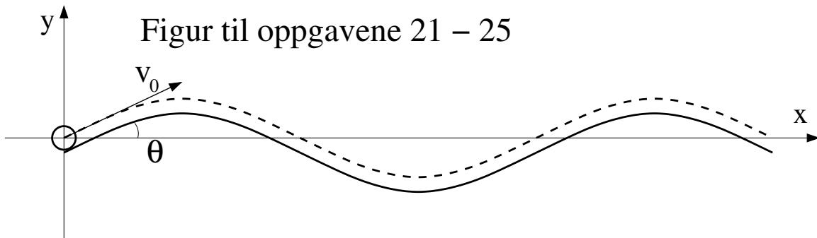
På en sinusformet bane (heltrukken linje) ruller ei kompakt metallkule med masse  $M$ , radius  $R$  og treghetsmoment  $I_0 = 2MR^2/5$ . Kula ruller rent (uten å slure), slik at kulas massesenter (CM) følger banen (stiplet linje)
