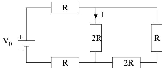
**40.** I figuren er  $V_0 = 9.0 \text{ V}$  og  $R = 2.0 \Omega$ . Hva er strømmen  $I$ ? (Se figur.)
