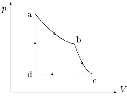
Figuren viser en reversibel kretsprosess for en ideell gass, bestående av en isoterm (a til b), en adiabat (b til c), en isobar (c til d) og en isokor prosess (d til a). Ranger temperaturene  $T_a$ ,  $T_b$ ,  $T_c$  og  $T_d$  i de fire tilstandene (hjørnene) merket a, b, c og d.
