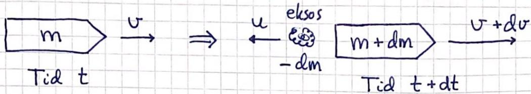
Eksos (masse  $-dm > 0$ ) sendes bakover med fart  $u < 0$  relativt raketten; pga impulsbevarelse får raketten økt fart  $dv$  i løpet av tida  $dt$ :
