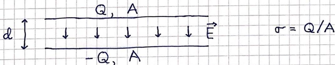
Med liten avstand  $d$  mellom platene blir feltet tilnærmet konstant mellom platene,
