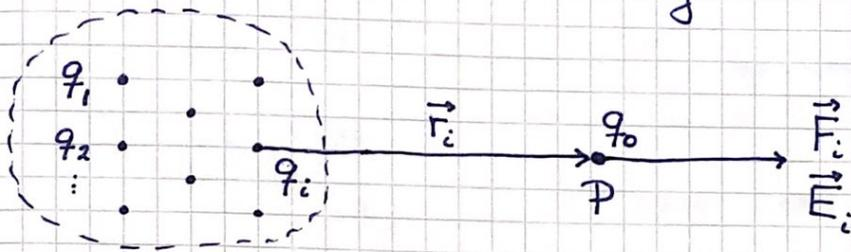
El. felt i posisjon P fra (ref.-)ladningene  $\{q_1, q_2, \dots, q_i, \dots\}$ :
