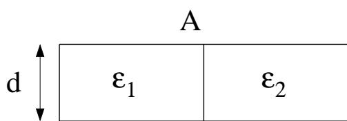
12) En platekondensator har metallplater med areal  $A$  og avstand  $d$  mellom platene. Volumet mellom platene er fylt med to like brede dielektriske skiver, som vist i figuren, med permittivitet hhv  $\epsilon_1 = 3\epsilon_0$  (til venstre) og  $\epsilon_2 = 2\epsilon_0$  (til høyre). Hva er kondensatorens kapasitans? (Tips: Dette kan betraktes som en parallelkobling av to kapasitanser.)
