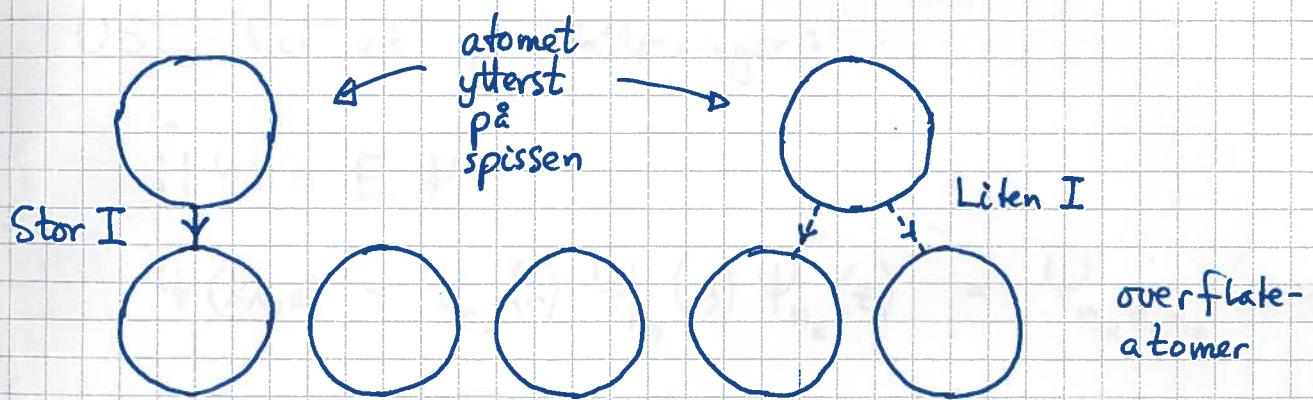
Tunnelningsstrømmen:  $I \sim T \sim \exp(-2\beta eL)$  er størst når atomet ytterst på tip-spissen er rett over et overflateatom. Ved å "scanne" tipen fram og tilbake over overflaten og måle  $I(x, y)$  oppnås en avbildning av overflaten på atomært nivå.
